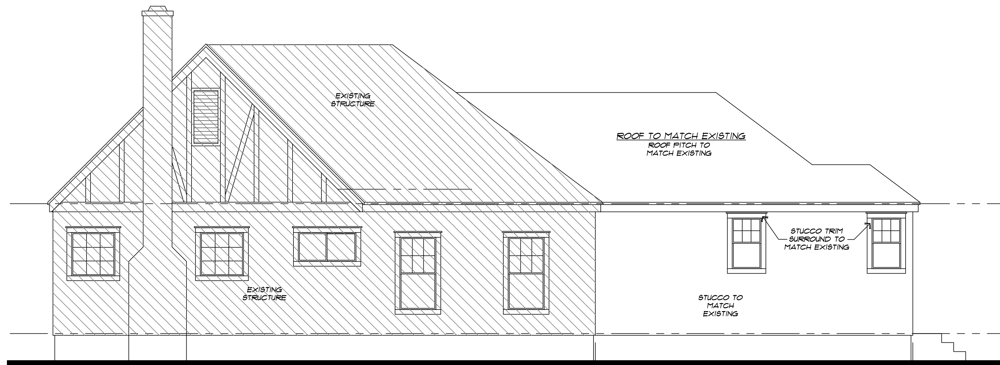
RIGHT ELEVATION SCALE: 1/4"=1'-0"
