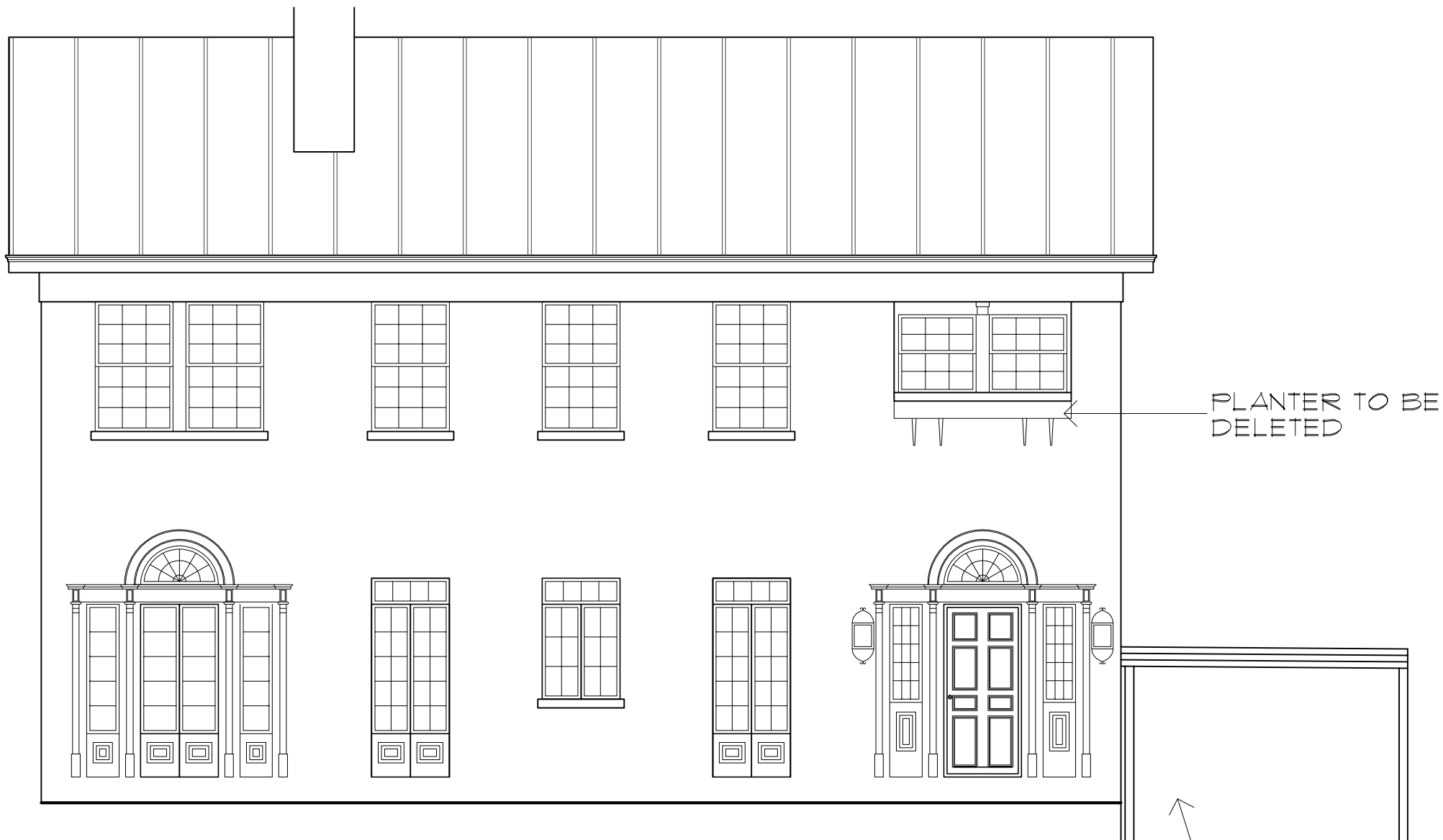
EXISTING FRONT ELEVATION SCALE: 1/8" = 1'-0"
