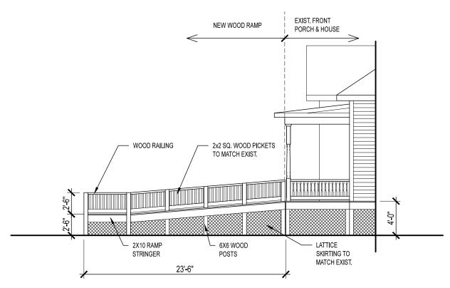
PARTIAL SIDE (SOUTH) ELEVATION
