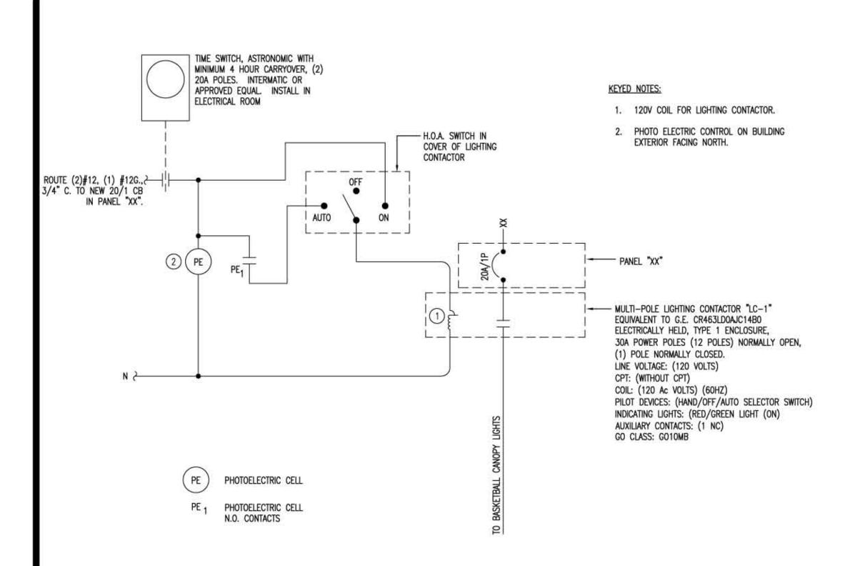
LIGHTING CONTACTOR CONTROL CIRCUIT DETAIL
